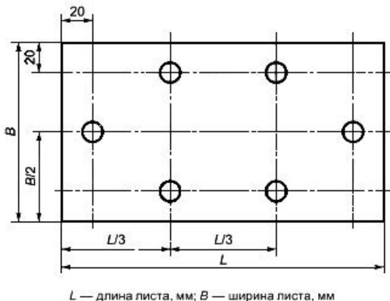
Рисунок 1 - Измерение толщины фанеры
